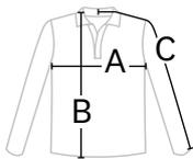
Alle Maßtabellen und Größenangaben unter Vorbehalt! Durch Schnittoptimierungen kann es zu geringfügigen Maßabweichungen kommen, weshalb wir eine Anprobe bei einem autorisierten HAKRO Fachhändler empfehlen. Maßtoleranzen bei A (=1/2-Oberweite), C (=Armlänge) +/- 1,5 cm und B (=Länge) +/- 2 cm.
